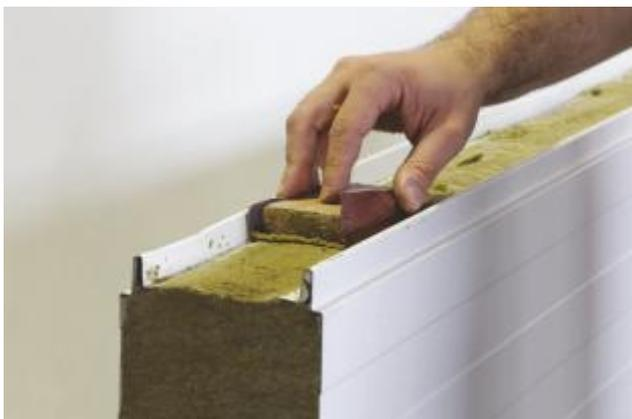
**Фото №5.** Процедура «выглаживания» поверхности замка GS MW
